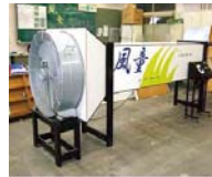
この装置内に風を起こす。内部にミニチュアサイズの風車を置き測定を行った。測定者は風を受けて、寒い思いをしただけ。
